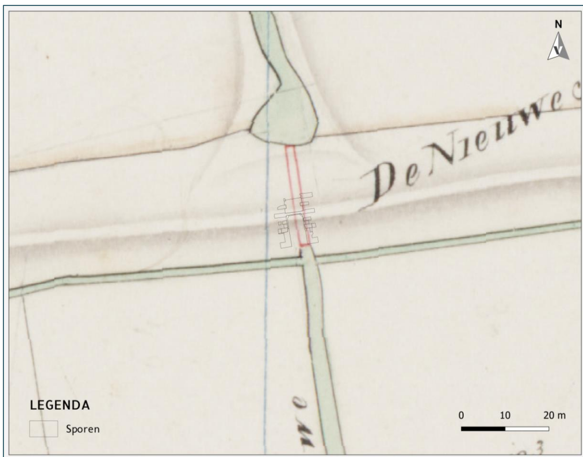
Afbeelding 19: De restanten van de sluisconstructie afgebeeld op de kadastrale minuut van 1811-1832. In rood de dunne lijn van de ligging van de sluisconstructie volgens de historische kaart, in dunne grijze lijnen de restanten van de sluis. Bron: Vestigia 2023 & Beeldbank RCE.
